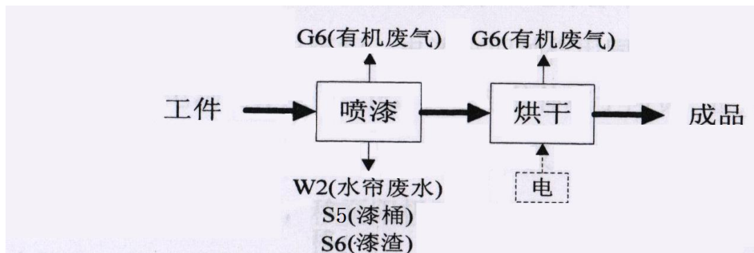
图5 喷漆处理的生产工艺及产污流程图
